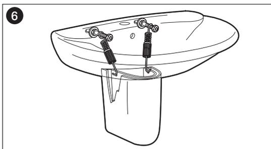
将半柱挂钩的一头上到脸盆的固定螺栓上，用六角螺母锁紧，拉紧弹簧将挂钩的另一头勾住半柱。
