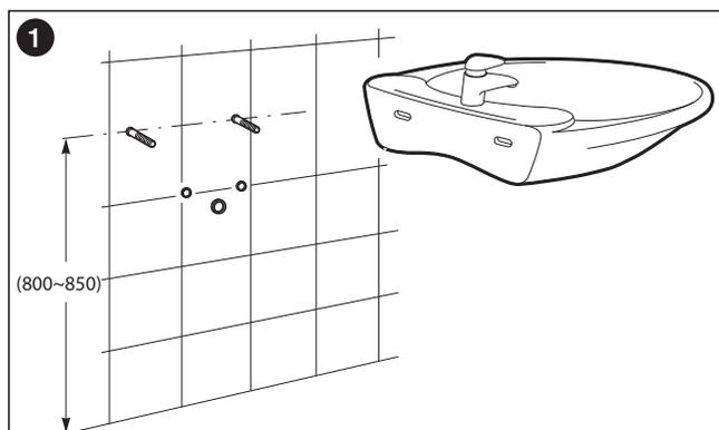
1 将洗脸盆放到安装位置，用水平尺矫正水平位置后，用笔在墙上标出。用冲击钻在作记号处钻孔，并安装膨胀管及螺栓。
