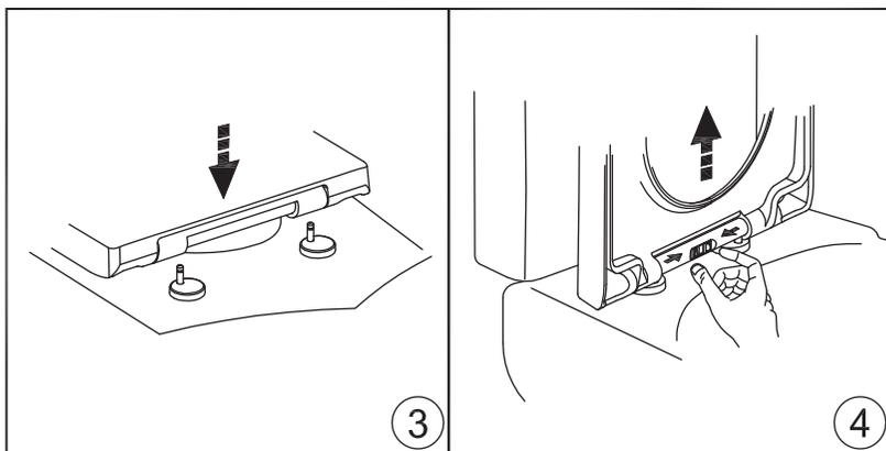
将盖板由上至下落下，使支座插入盖板铰链套内即可。
