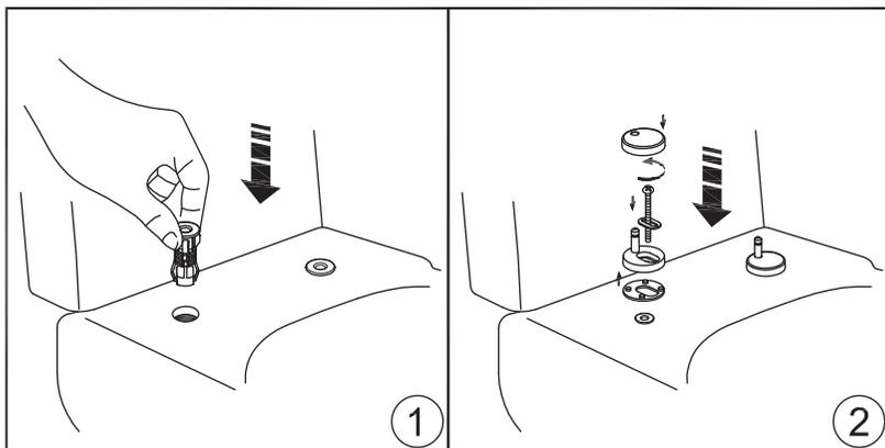
将膨胀套钉压入孔内，安装螺钉将支座固定在陶瓷体上稳固。
