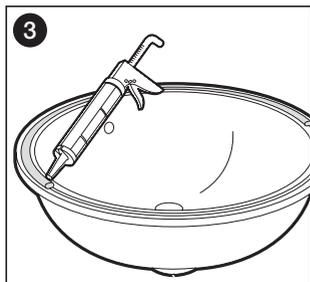
把洗脸盆放平，在洗脸盆边缘上口涂上硅胶类密封材料。
