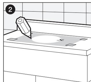
根据切割图纸，定出洗脸盆的安装位置。用笔沿洗脸盆切割图纸边缘将洗脸盆的轮廓描绘在台面上。
