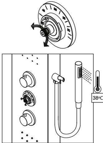
2. Seleccionar la temperatura girando el eje del cartucho hasta que la temperatura indicada en el termómetro sea de 38°C.
