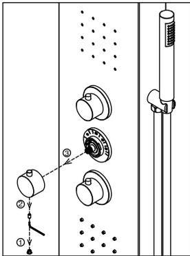
1. Desmontar la cruceta de temperatura con la cruceta orientada según la imagen y siguiendo la secuencia.
