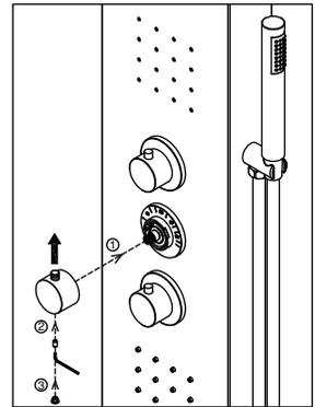
3. Volver a montar la cruceta de temperatura orientando la cruceta según la imagen y siguiendo la secuencia.
